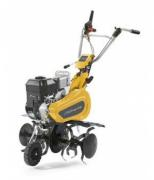
Культиватор SRC 775 RG - это мощный агрегат, подходящий для подготовки почвы под посадку овощей. Он оборудован двигателем GGP TM 60 Series объемом  $182 \, \mathrm{cm}^3$ , обеспечивающим превосходную производительность даже на твердых грунтах. Шесть почвофрез и защитные диски обеспечивают рабочую ширину 75 см и глубину вспашки 24 см. Данная модель имеет две передачи — для движения вперед и назад, поднимающееся транспортное колесо и регулируемую по высоте и ширине рукоятку.
