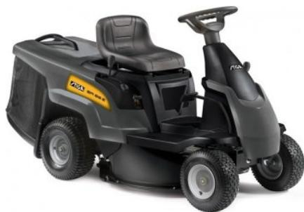
Stiga SR 66 E обладает мощностью двигателя 3.5 л.с., ширина режущей деки 66 см. Большой ассортимент навесного оборудования позволит использовать садовый трактор в качестве снегоуборщика, культиватора, опрыскивателя, для перевозки инструментов в тележке.
