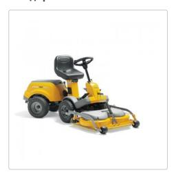
Райдер Park 340 MX - это агрегат с шарнирно-сочлененным управлением 50/50, у которого задние колеса с точностью повторяют траекторию передних. Райдер оснащен бензиновым двигателем Briggs & Stratton мощностью 10 кВт, гидростатической трансмиссией и педальным управлением, позволяющим плавно регулировать скорость. А полный привод гарантирует отличную проходимость.
